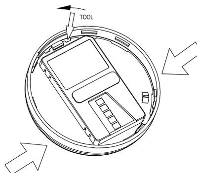
Remova a capa, abra a câmara do detector e limpe-a cuidadosamente.
