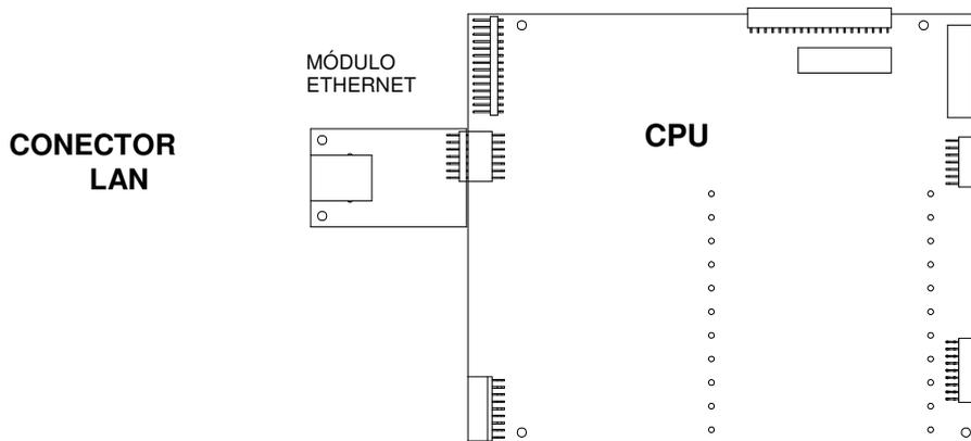
Existe uma porta LAN para conexão com a rede.
